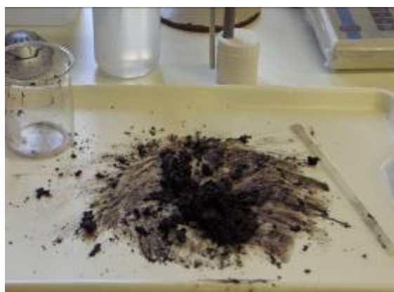
Bandeja com substrato saturado. Beacker, relógio e pisseta no canto superior esquerdo. Bastão a direita.
